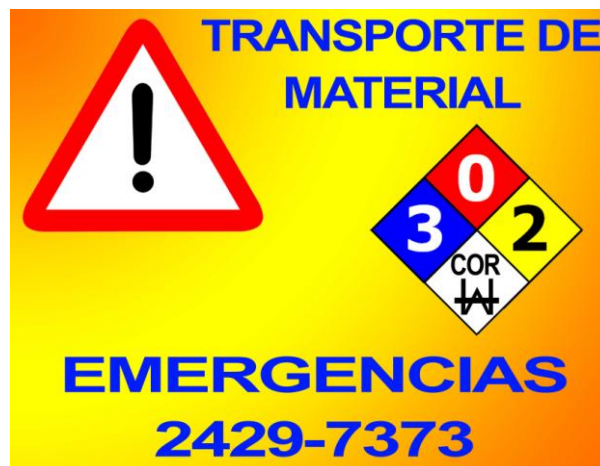
Figura 2. Rotulado que se utiliza para el transporte de baterías ácido - plomo usadas para identificar los riesgos expuestos.
